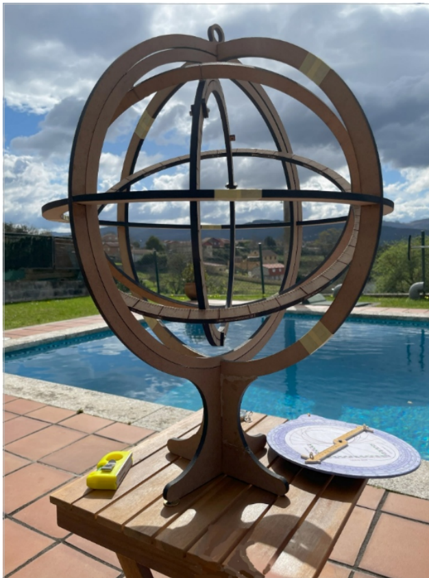
Figura 8. Correctamente nivelado, orientado y apuntado el instrumento al Sol, en 352^\circ , piscis, 11 de marzo de 2025, 12:19 p.m.CET. La parte delantera del anillo eclíptico hace sombra sobre la parte interior cóncava de mismo anillo eclíptico. El anillo eclíptico queda paralelo al plano eclíptico.
